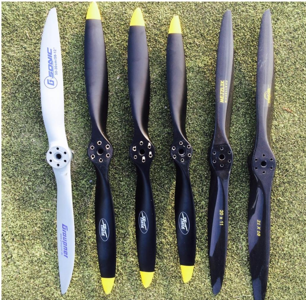
Abbildung 1: Getestete Propeller; G-Sonic ist aus verstärktem Kunststoff, die Fiala-Props sind aus Buchenholz, die Mezliks aus Kohlefaser/Holzverbund.
