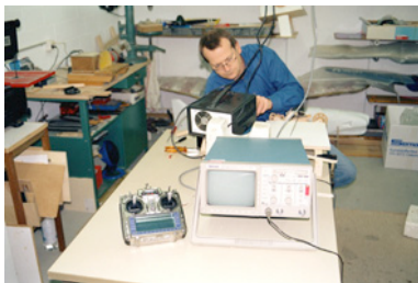
Bild 5 Erich Wächter an der Arbeit. Am Oszillograph im Vordergrund wird die Stellzeit abgelesen. Mit dem 9Z Sender werden die Futaba Servos angesteuert.
