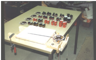
Bild 3 Die Testkandidaten auf einen Blick, es fehlen nur noch die beiden Digitalservos von Hitec (Vordergrund links). Auch das etwas grössere Powerservo von Multiplex präsentiert sich hier noch anstelle des Profi BB, es wurde aber später durch dieses ersetzt.
