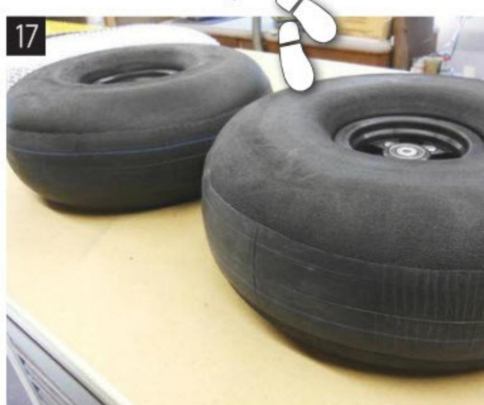
Den verbleibenden Schlauchring stülpt man über das Rad und schützt somit die Lauffläche – fertig sind unsere Tundra-Reifen.
