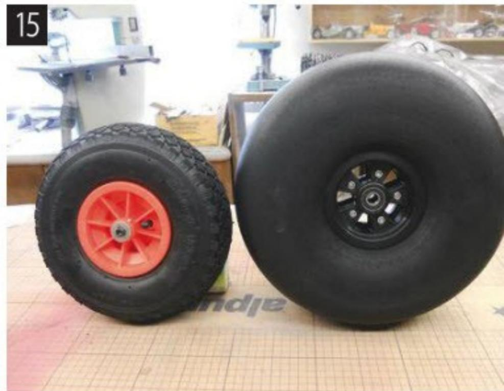
Im Vergleich zum Baumarkt-Rad: Der Tundra-Reifen hat 320 mm Durchmesser und ist kugelgelagert. Das Baumarkt-Rad bringt 1.000 g auf die Waage, das Eigenbau-Tundra-Rad nur 750 g.
