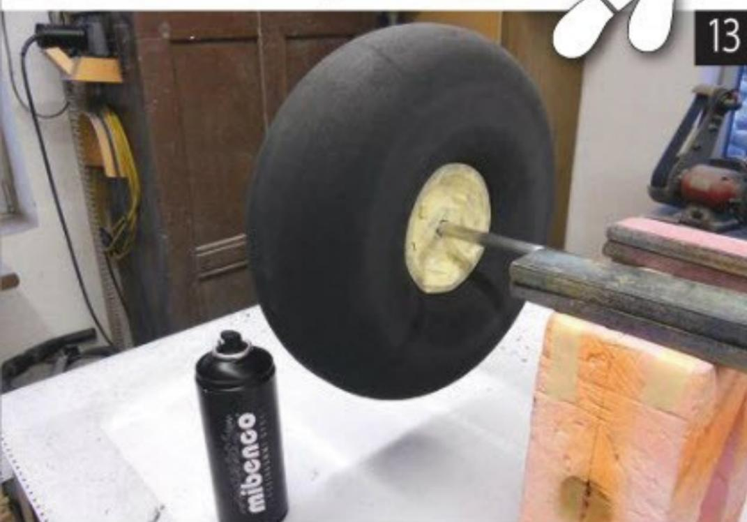
Ist die endgültige Form erreicht, deckt man die Felge ab und spritzt eine ganze Dose Gummi auf den Reifenrohling.
