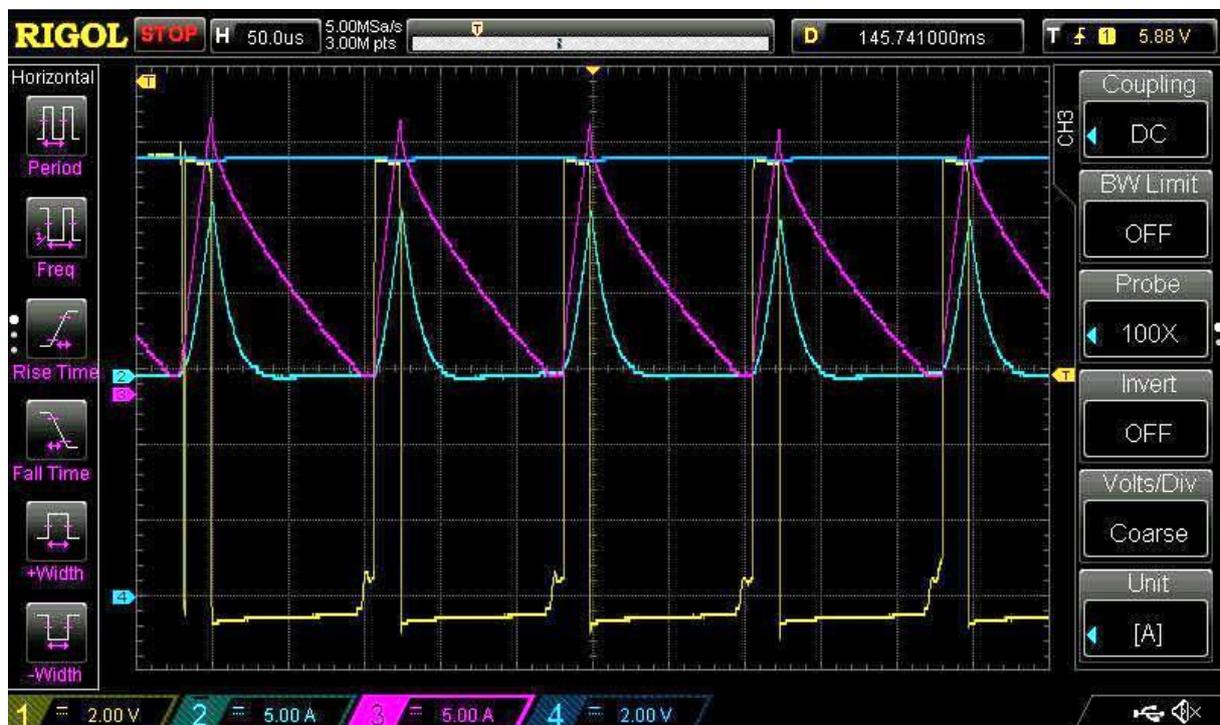
PWM: 8 kHz bei  $I_{bat} = 0.8 \text{ A}$  (im Mittel), Stromspitzen von 10 A bzw. 18 A in Motorphase!
