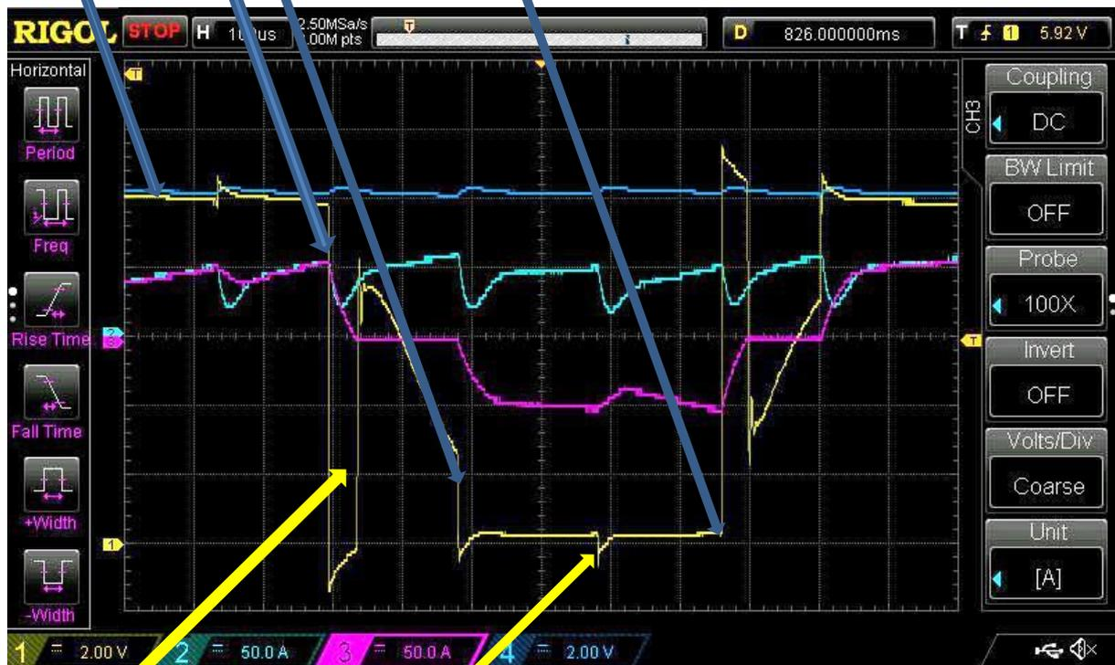
Deutlich sichtbar sind jeweils die Spannungs-Zeit Flächen die  $L \cdot I_{\text{peak}}$  entsprechen und durch den Abbau der gespeicherten Energie im Magnetfeld der Wicklung entstehen. Die Energie wird dabei teilweise in die Batterie bzw. in die benachbarte Wicklung zurückgeführt wodurch während dieser Zeit ein Stromminderverbrauch aus dem Akku resultiert infolge Blindstroms.
