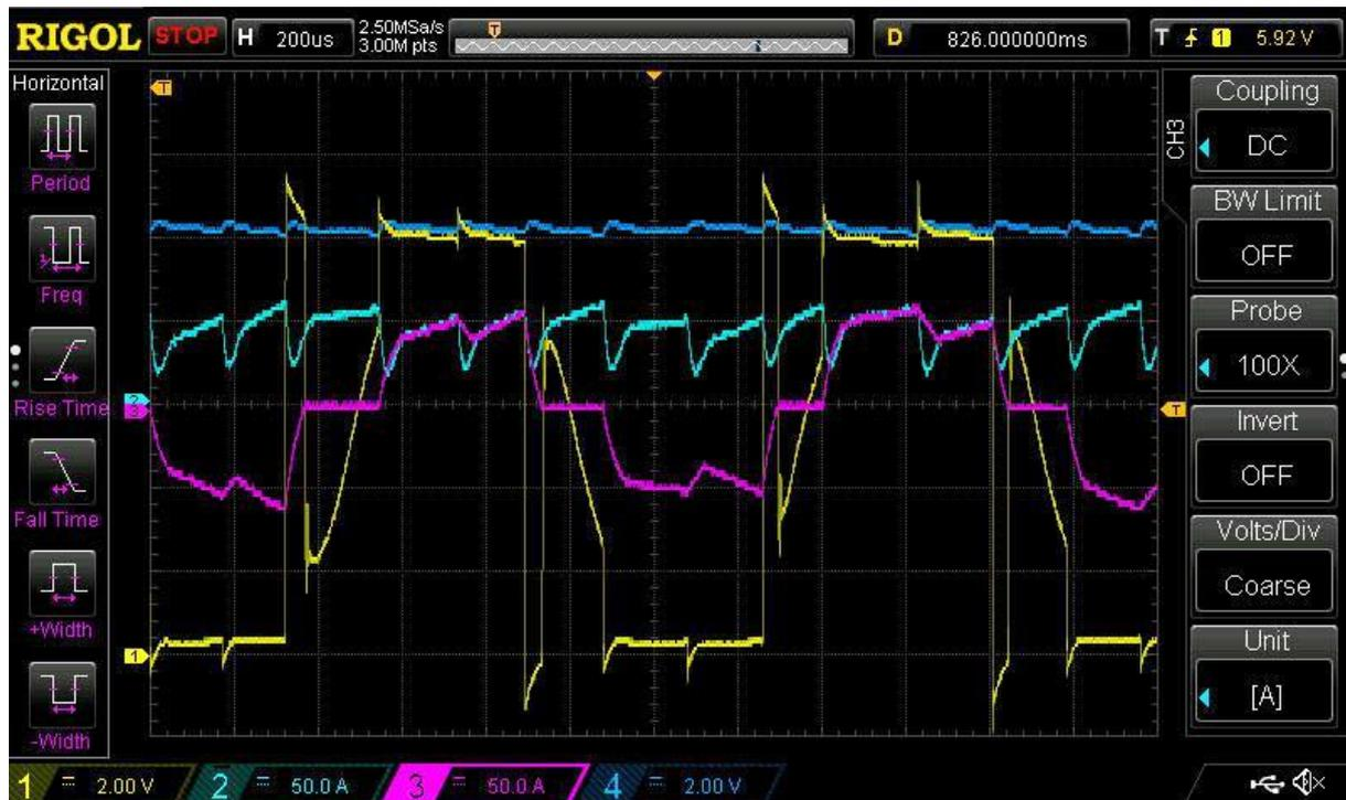
(2,3) Motor und Akkustrom sinken auf ca. 42 A (Maximalwert gem. Datenblatt!)
