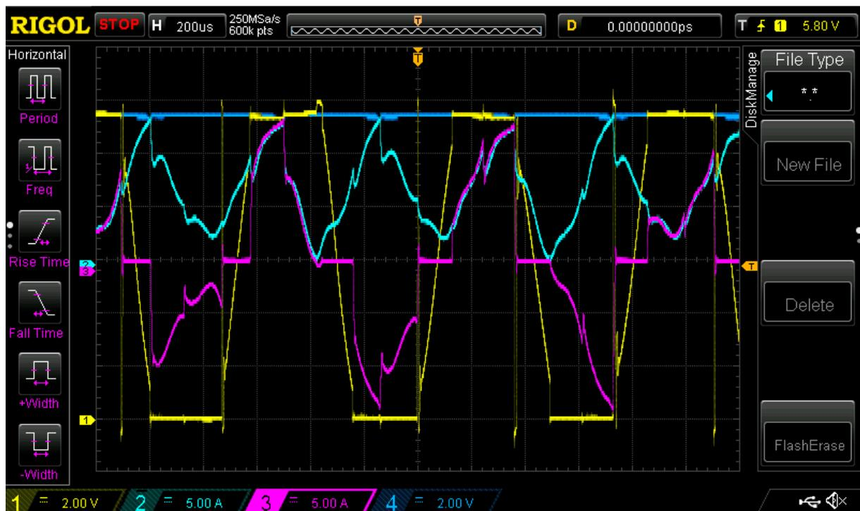
Der  $I_o$  von ca. 6 A bei maximaler Drehzahl scheint relativ hoch!
