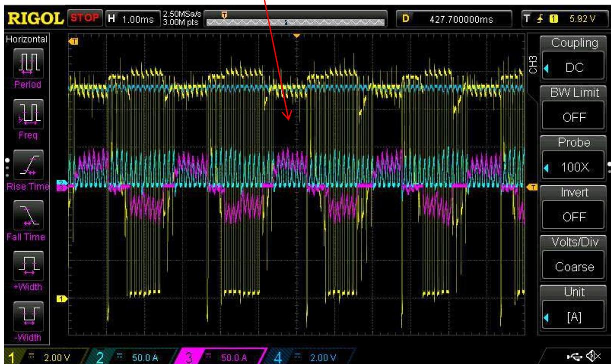
Hier sieht alles noch sehr manierlich aus. Drehzahl=  $1000 / (6/4 * 10.3 \text{ ms}) * 60 = 3900 \text{ 1/Min.}$
