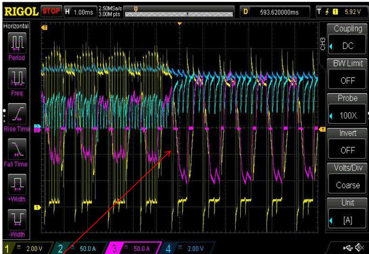
**Hier geht's zur Sache, der Regler schaltet Rampe und PWM aus und geht auf Vollspannung!**
