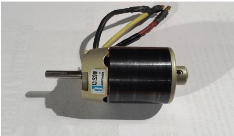
$N = 1000 / 0.77 / 12 * 2 * 60 = 13'000 \text{ 1/Min.}$     (Gemäss Datenblatt im Anhang:  $12 * 1100 = 13'100 \text{ RPM}$ )
