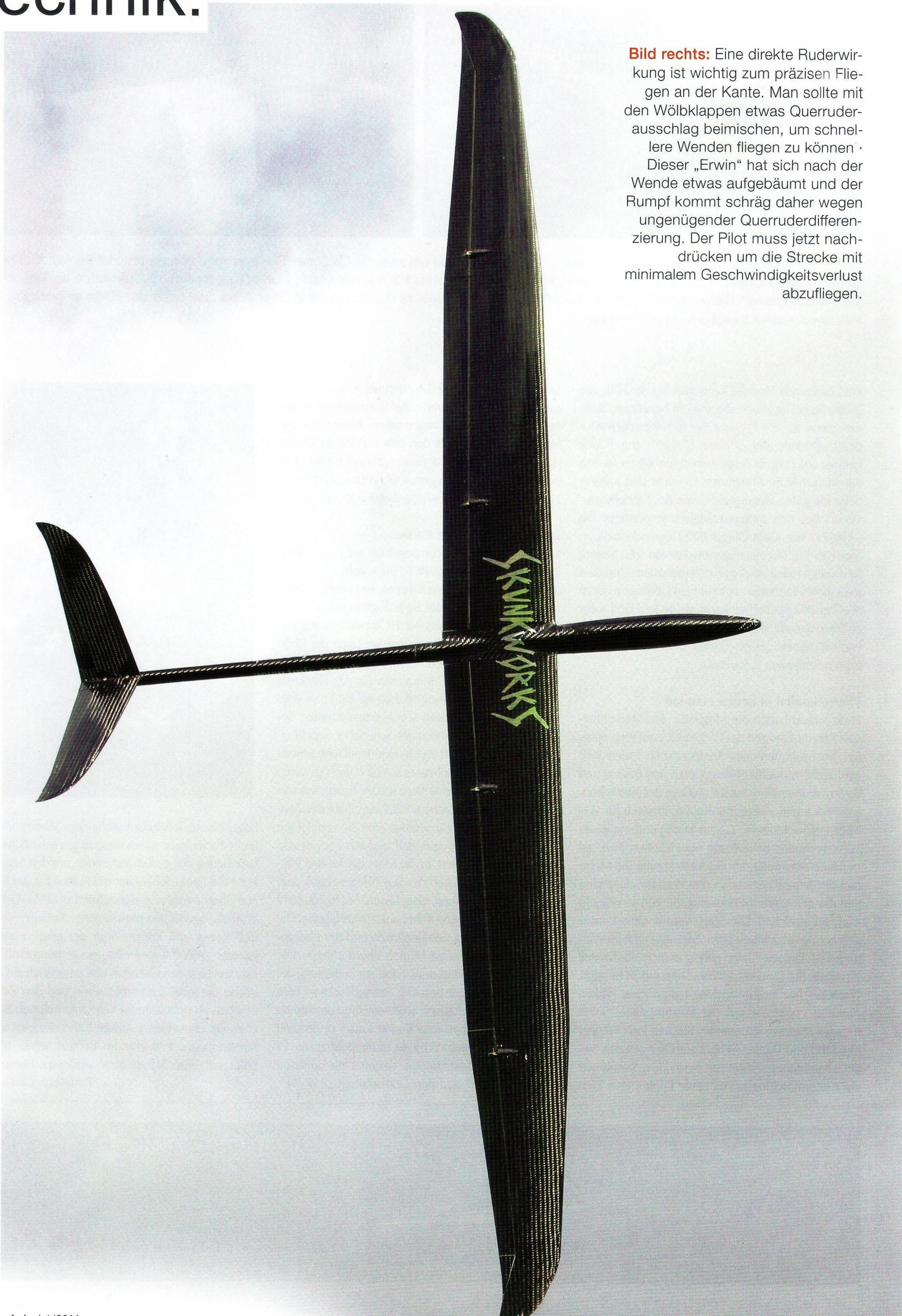
**Bild rechts:** Eine direkte Ruderwirkung ist wichtig zum präzisen Fliegen an der Kante. Man sollte mit den Wölbklappen etwas Querruderausschlag beimischen, um schnellere Wenden fliegen zu können. Dieser „Erwin“ hat sich nach der Wende etwas aufgebäumt und der Rumpf kommt schräg daher wegen ungenügender Querruderdifferenzierung. Der Pilot muss jetzt nachdrücken um die Strecke mit minimalem Geschwindigkeitsverlust abzufliegen.
